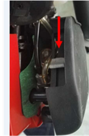
Clapet de démarrage fermé (levier du volet de démarrage vers le bas)
